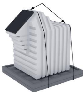
Místo instalace napínačů
